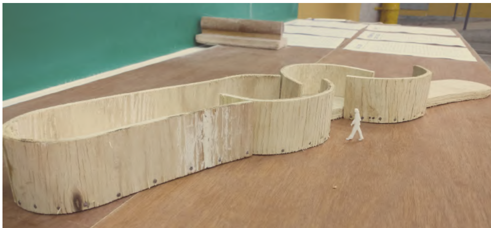
Figura 33 - Modelo de estudo na escala 1:50 de proposta para os vestiários em hiperadobe Fonte: Caetés, 2017
