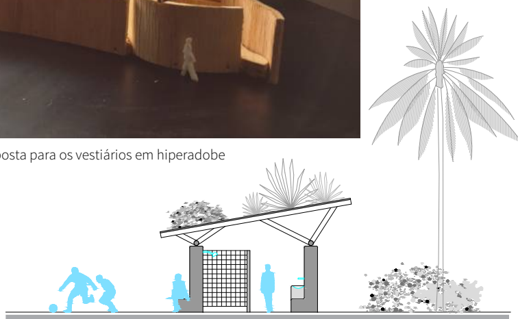
Figura 31 - Corte esquemático de proposta para o vestiário em hiperadobe. Fonte: Caetés, 2017 escala gráfica abaixo
